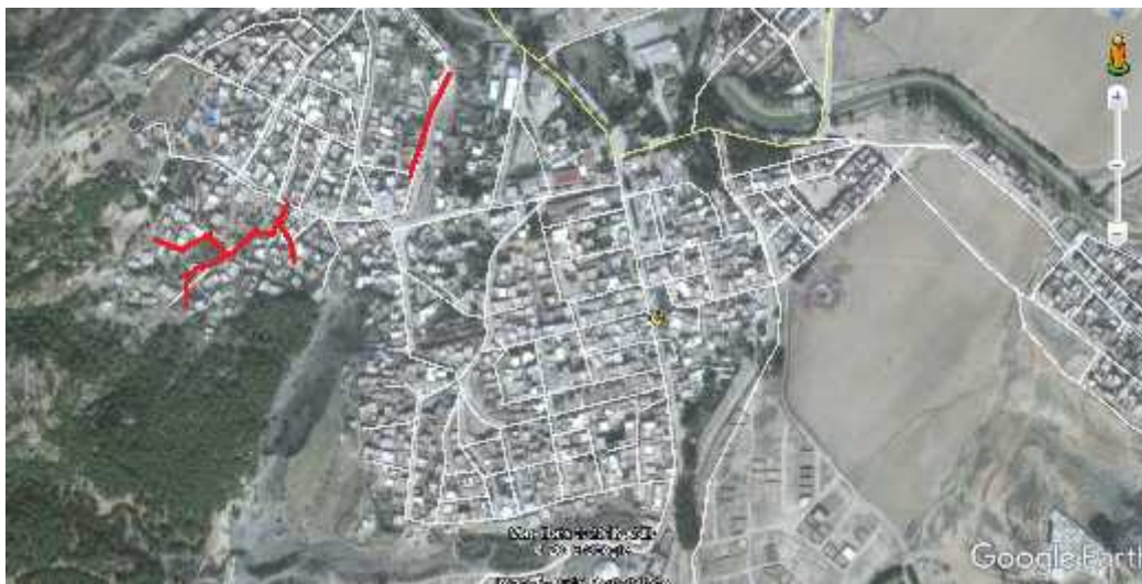
Figure 3: Plan du réseau d'assainissement à réaliser
