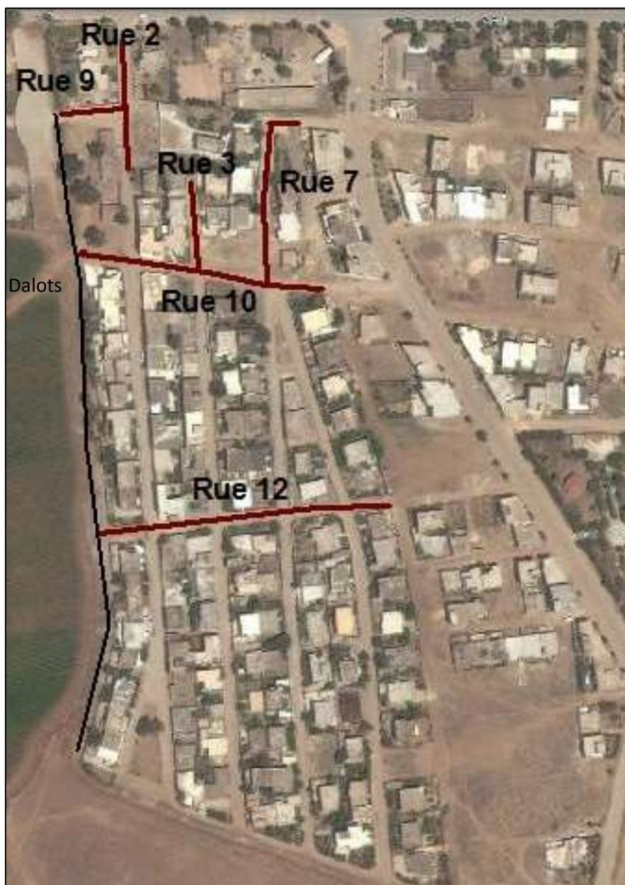
*Figure 4: Réseau d'évacuation des eaux pluviales dans le quartier El Ayachi*
