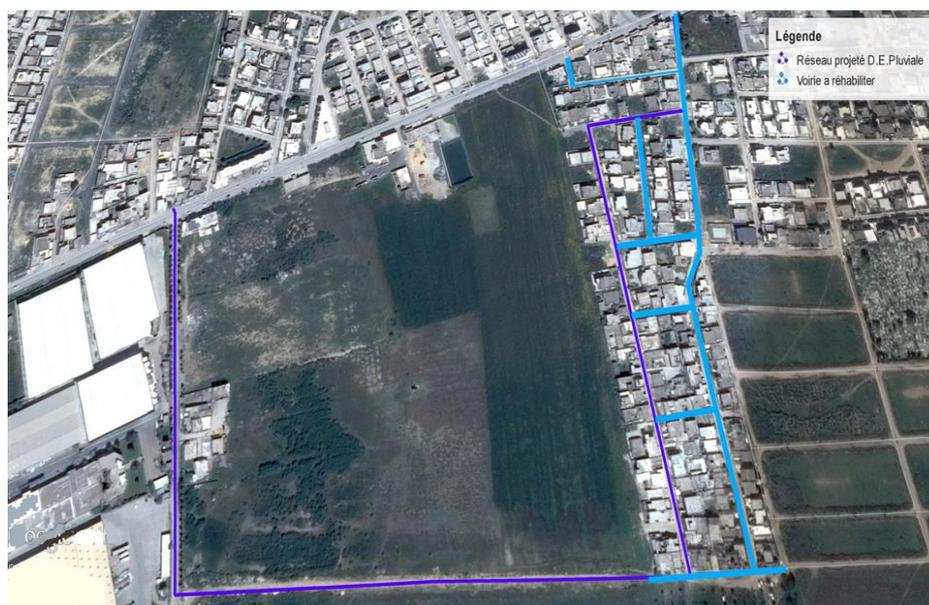
Figure 7-2: Réseau de drainage de l’eau pluviale projetée
