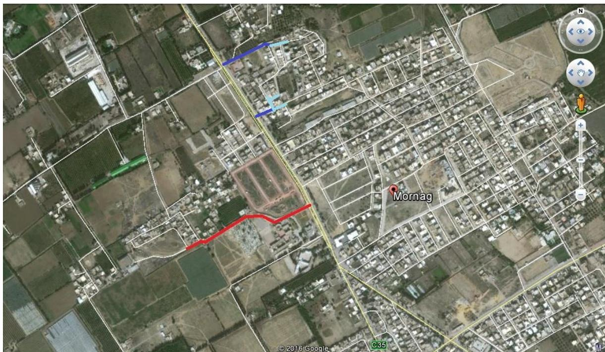
**Figure 3 : Réseau de drainage des eaux pluviales aux quartiers Douimsi et Doukali**
