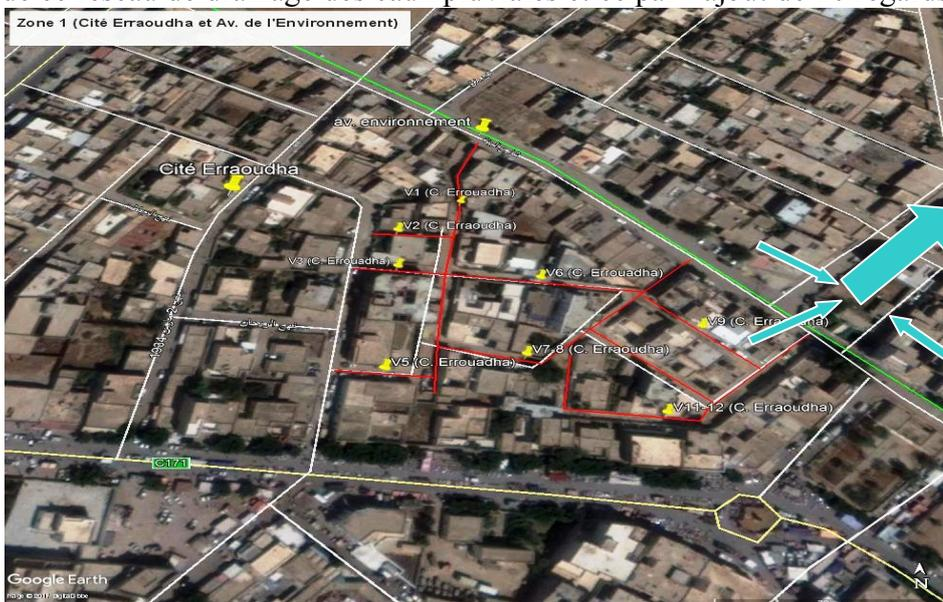
**Fig 5** :La commune propose de renforcer le réseau de drainage au niveau du Point bas à l'avenue de l'Environnement.
