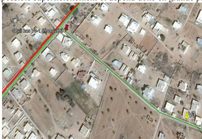
Fig 5 : un Point bas à la voie V3 (mosquée dont la côte seuils est située en dessous du niveau de la voirie) problème traité au niveau d la consultation et la solution convenue consiste en la surélévation de la côte seuil à la charge des riverains
